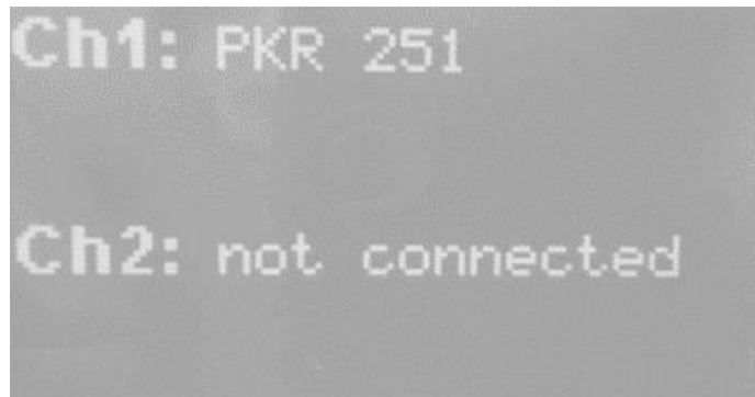
شکل ۵-۲: نمای صفحه ی نمایشگر در هنگام اتصال کابل برق و تشخیص فشارسنج
